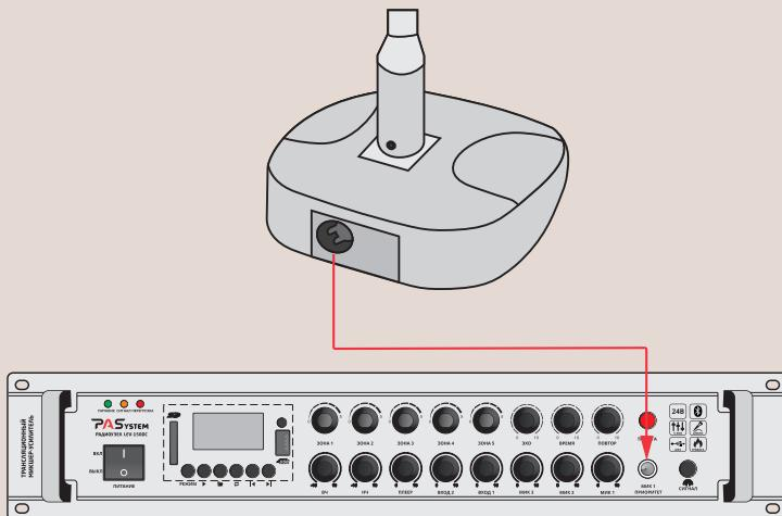
Подключите микрофон к разъёму XLR кабелем, входящим в комплект поставки. Разъём Джек TRS, подключите в микрофонный вход микшера-усилителя. Вставьте батарейки.
